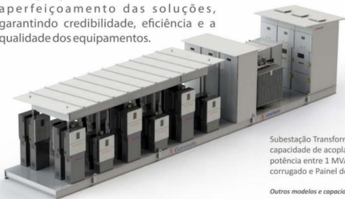
Subestação Transformadora / Inversora modelo com capacidade de acoplamento de inversores totalizando potência entre 1 MVA até 7,8MVA, com Transformador corrugado e Painel de Média Tensão 15, 24 ou 36KV.
